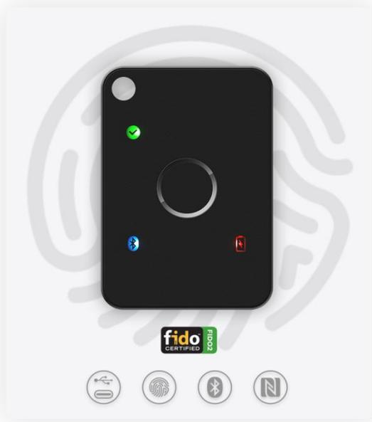
此外，飞天诚信提供的移动端 SDK 可方便客户和开发者将 FIDO 认证集成在自己的应用里。作为通过 FIDO 认证的安全设备，AllinPass Security Key 能够有效的防止钓鱼网站以及中间人攻击。其采用了 CC EAL 6+ 认证过安全芯片，能够提供芯片级的安全防护和成熟的安全算法，以保证用户的数据安全。
